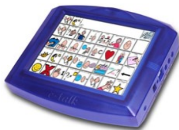
Figura 1.2: Un dispositivo VOCA per la comunicazione attraverso simboli.
