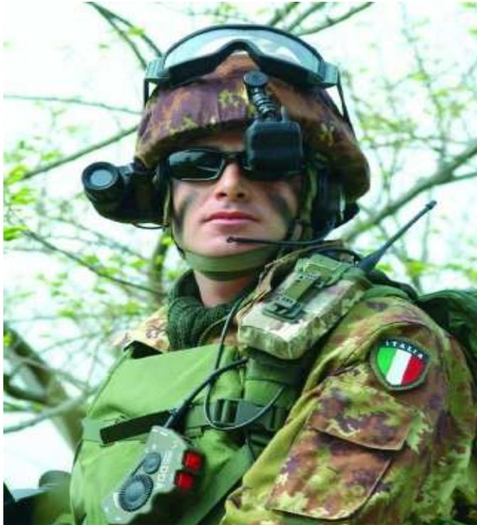
Figura 5.1. Nuovo elmetto del progetto “Soldato Futuro”, nell’immagine, l’oculare Nimos, il nuovo binocolo visione notturna e diurna, occhiali balistici anti-laser, microfono labiale e microauricolare.
