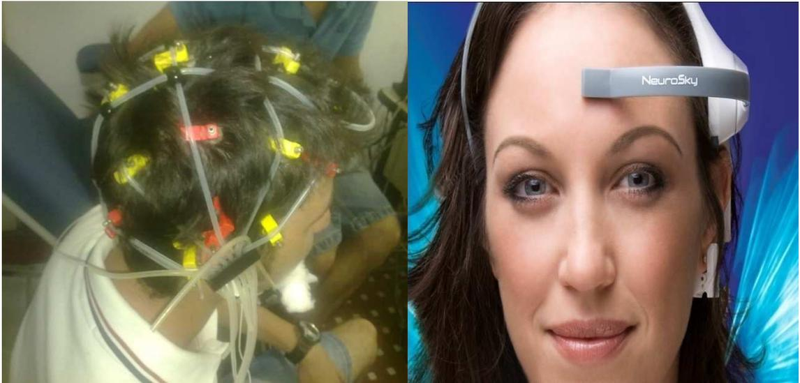
Figura 6.17. A sinistra, è rappresentato un montaggio EEG realizzato in laboratorio secondo le prescrizioni raccomandate in letteratura. A destra, il montaggio dell'elettrodo frontale di Mindwave. Come è possibile notare, nei montaggi EEG clinici non vengono posizionati elettrodi sulla fronte.
