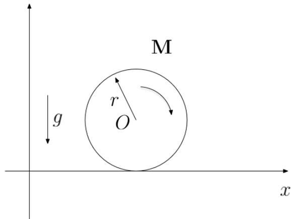
**Soluzione** Per permettere il rotolamento della sfera nella direzione positiva dell'asse  $x$ , la componente orizzontale della reazione vincolare  $f$  deve essere diretta nel verso negativo dell'asse.
