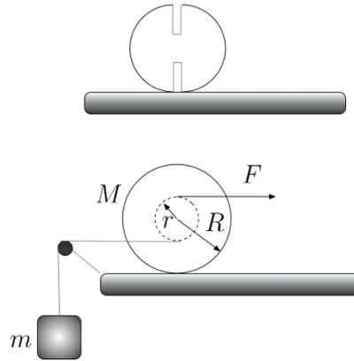
sfera intorno alla quale è avvolto un filo inestensibile cui è attaccato un corpo di massa  $m$  soggetto all'azione della gravità. Il raggio della scanalatura attorno a cui si avvolge il filo è  $r = 11 \text{ cm}$ . Alla scanalatura è applicata una forza  $F$  verso destra tale per cui si mantiene il sistema in equilibrio statico.
