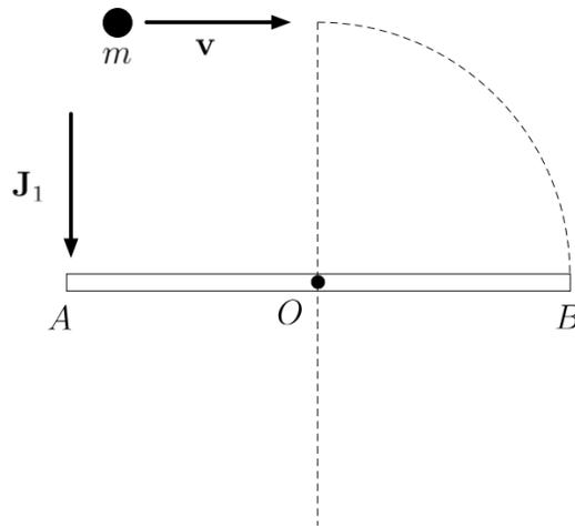
costante di valore  $M_a = 0.37 \text{ Nm}$  che si oppone alla rotazione dell'asta. All'inizio la sbarra è ferma in posizione orizzontale quando al suo estremo  $A$  viene impartito per mezzo di una martellata un impulso  $\mathbf{J}_1$  diretto verso il basso. In seguito a tale colpo, l'asta inizia a ruotare con velocità angolare iniziale  $\omega_0 = 10.8 \text{ rad/s}$ .
