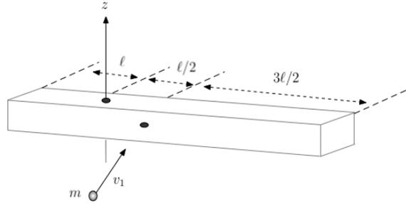
Un proiettile di massa  $m = 22 \text{ g}$  e velocità  $v_1 = 300 \text{ m/s}$  colpisce l'asta nel suo centro e rimbalza all'indietro con velocità  $v_2 = 50 \text{ m/s}$ . Il moto dell'asta e del proiettile avviene nello stesso piano orizzontale. Si calcolino la frequenza angolare dell'asta appena dopo l'urto  $\omega_0$ , l'impulso  $J$  subito dall'asta al momento dell'urto e l'impulso subito dall'asse  $J_z$ .
