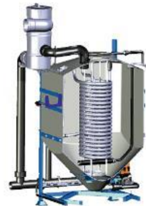
Scambiatore di calore nel primo stadio del Pontos AquaCycle
