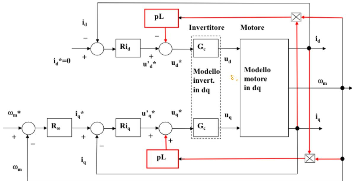
In rosso le azioni di disaccoppiamento degli assi per trasformare il sistema 2\_IN/2\_OUT in due sistemi 1\_IN/1\_OUT
