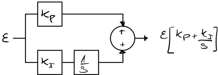
$$f_{dt} : k_p + \frac{k_I}{s} = k_p \left[ 1 + \frac{k_I/k_p}{s} \right] = k_p \left[ \frac{s + k_I/k_p}{s} \right]$$
