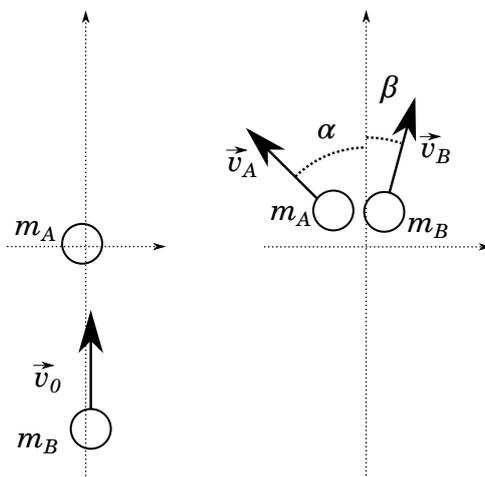
**a)** L'impatto trasferisce al mezzo  $A$  una certa quantità di moto. Subito dopo l'urto  $A$  si trova quindi in moto con una data velocità  $v_A$ . Da quell'istante in poi,  $A$  si muove di moto uniformemente decelerato, dovuto alla forza di attrito che si sviluppa tra gli pneumatici e l'asfalto.
