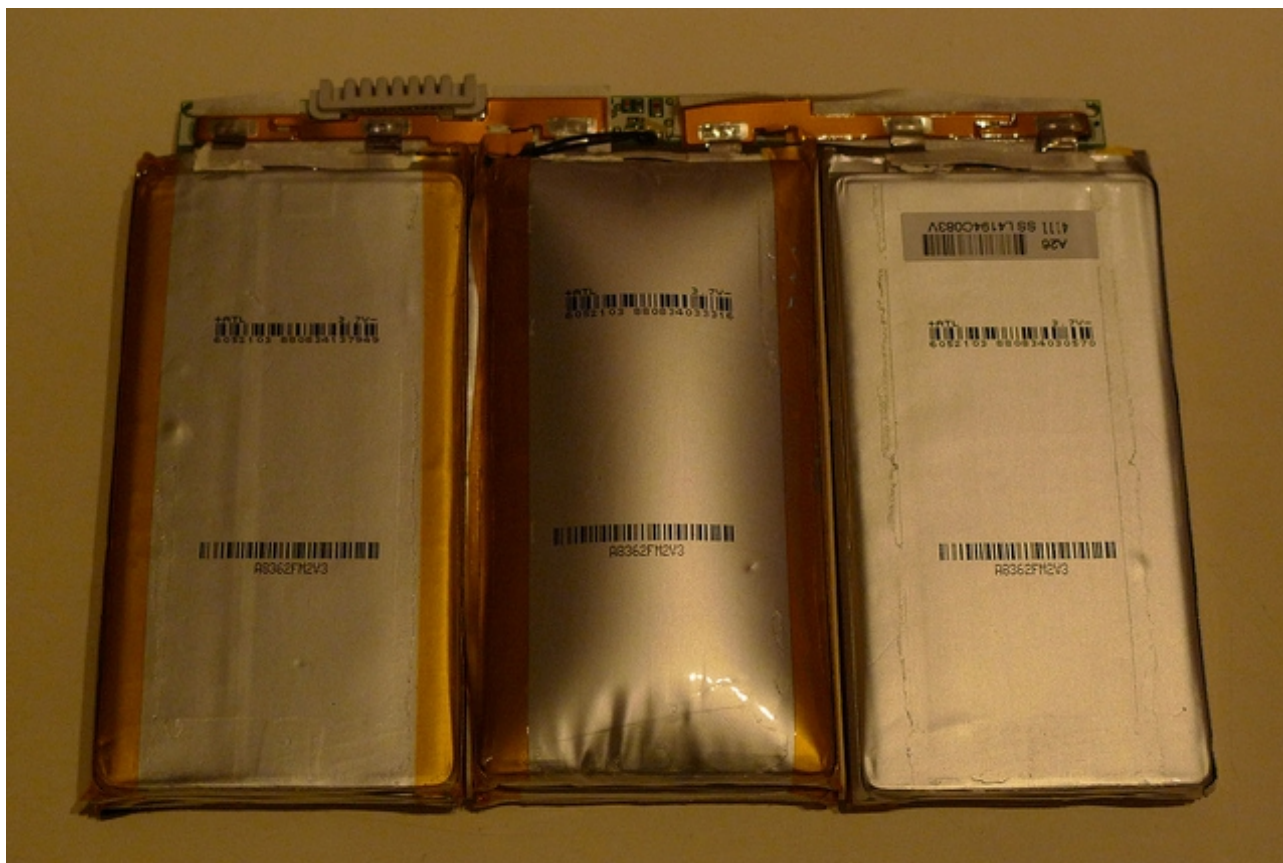
CELLA DIFETTOSA DI UN PACCO BATTERIE
