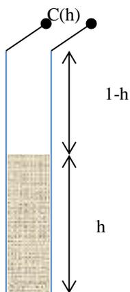
Si tratta di 2 condensatori in parallelo: uno costituito dalla porzione  $h$  del misuratore riempita di olio e l'altro della porzione rimanente  $1-h$  (cioè  $(uno - h)$ ,  $h$  in metri) riempita di aria.
