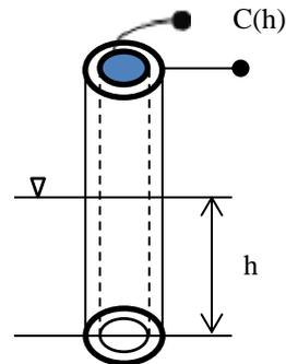
Le armature sono costituite dai due cilindri coassiali e il  $C(h)$  si può così disegnare:
