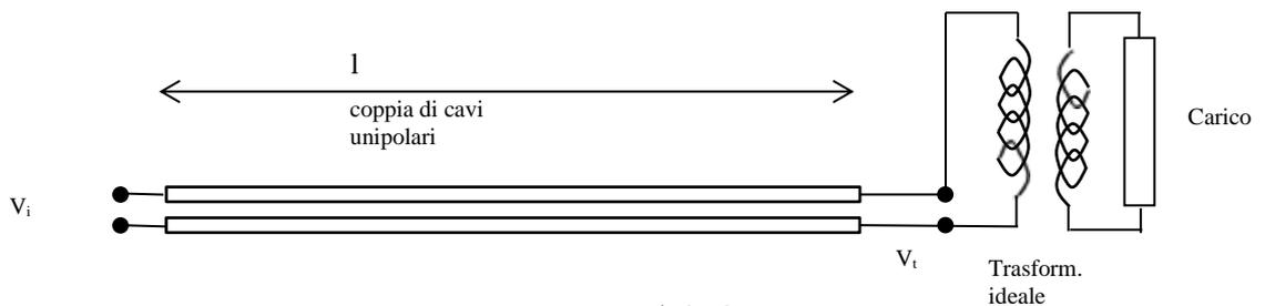
Il carico ha  $P = 2000W$ ,  $N = P/\cos\phi = 2500VA$ ,  $\sin\phi = 0.6$ ,  $Q = N\sin\phi = \sqrt{N^2 - P^2} = 1200\text{ var}$ .
