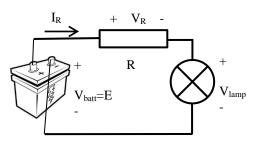
**ESERCIZIO 1** (max punti 6) – È data una lampada ad incandescenza da 12 V, 48 W. Si vuole alimentarla con una batteria avente tensione ai morsetti E=24 V. Determinare (trascurando la resistenza interna della batteria):
