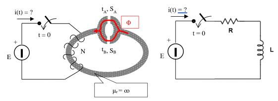
Assumendo il campo magnetico perfettamente canalizzato nel circuito magnetico (compresi i traferri) e solo lì presente, determinare
