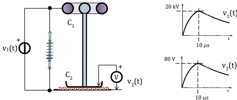
Le tensioni  $v_1(t)$  e  $v_2(t)$  rispettivamente applicata all'apparecchiatura in prova e misurata dal voltmetro, sono mostrate a destra. Il condensatore  $C_2$  è costituito da due piastre piane (quella superiore a bordi arrotondati) con una superficie affacciata di  $0.5$  m<sup>2</sup>, distanziate da un foglio di materiale dielettrico avente costante dielettrica relativa  $\epsilon_r = 3$  e spessore di  $0.8$  mm.
