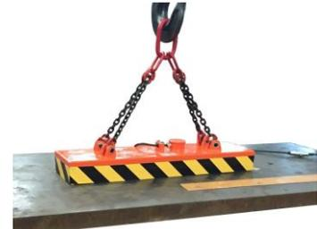
Figura di sollevatore magnetico di lastre ferrose che sfrutta una struttura del tipo di quella dell'esercizio proposto.
