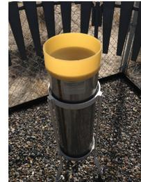
Un **pluviometro** (noto anche come **udometro**) è uno strumento utilizzato da meteorologi e idrologi per raccogliere e misurare la quantità di precipitazioni liquide in un determinato periodo di tempo
