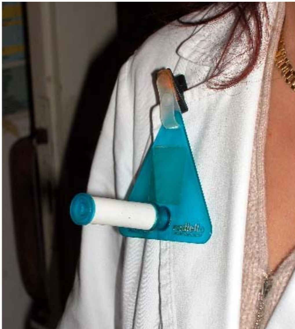
CAMPIONATORE PASSIVO RADIELLO® (modalità d'uso)
