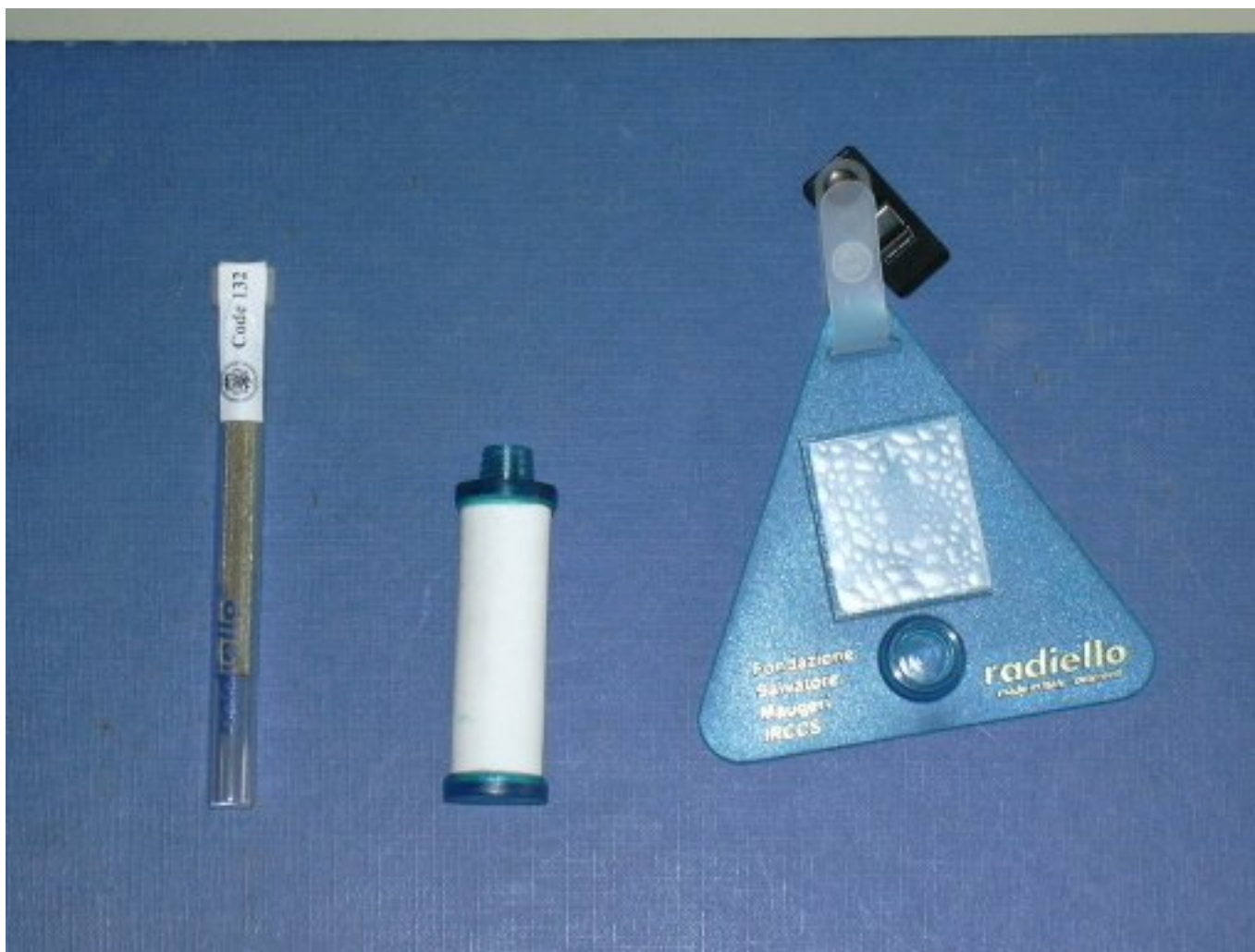
CAMPIONATORE PASSIVO RADIELLO® PER SOLVENTI retinatura in policarbonato; substrato carbone attivo
