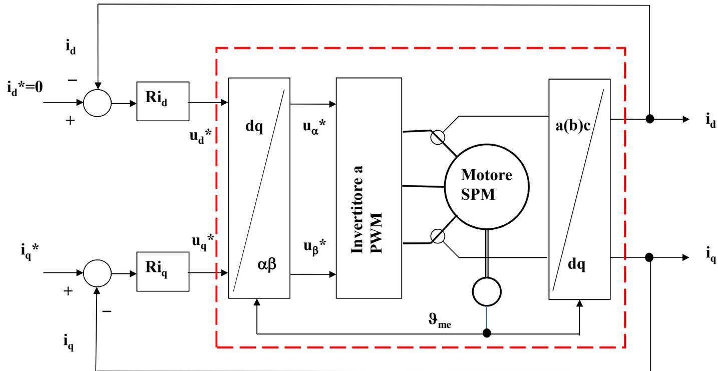
Modello in dq del sistema invertitore-motore.
