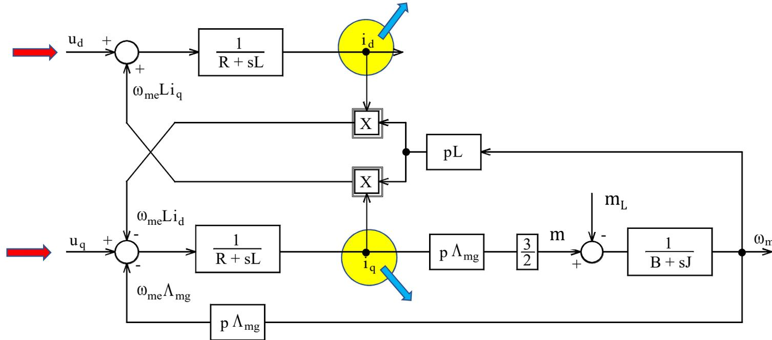
Nel sistema di riferimento dq la dinamica tensione-corrente del motore SPM è quella di un **sistema a due ingressi e due uscite**.
