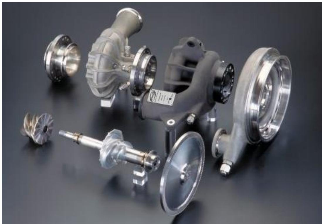
Turbopompa del motore Merlin del lanciatore SpaceX Falcon 9: peso circa 70 kg, potenza 1860 kW
