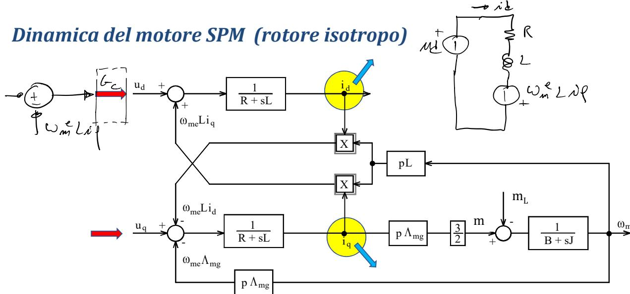
Nel sistema di riferimento dq la dinamica tensione-corrente del motore SPM è quella di un **sistema a due ingressi e due uscite**.
