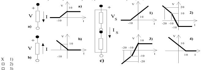
nessuna delle caratteristiche statiche 1), 2), 3), 4) corrisponde a quella del bipolo c)
