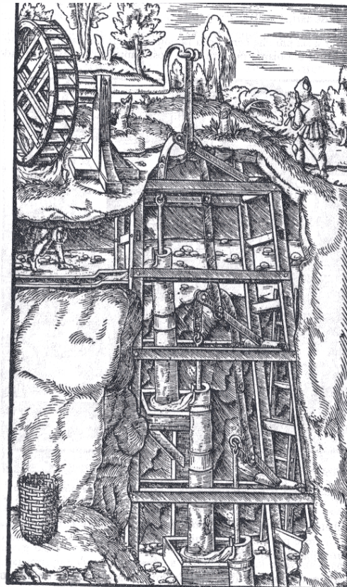
FIGURA 20—Drenaggio di una miniera. Pompa aspirante a tre stadi, azionata da una ruota a pale.
