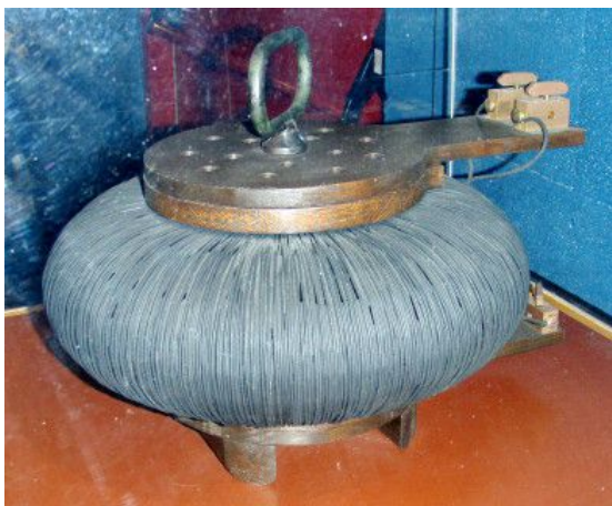
1885: trasformatore a nucleo chiuso O. T. Bláthy (H) alla Ganz (Budapest)
