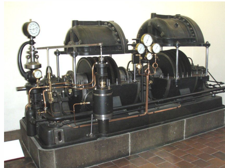
1903: Turbina ad azione Esher Wiss 11 bar 365 kW Deutsches Museum - Monaco
