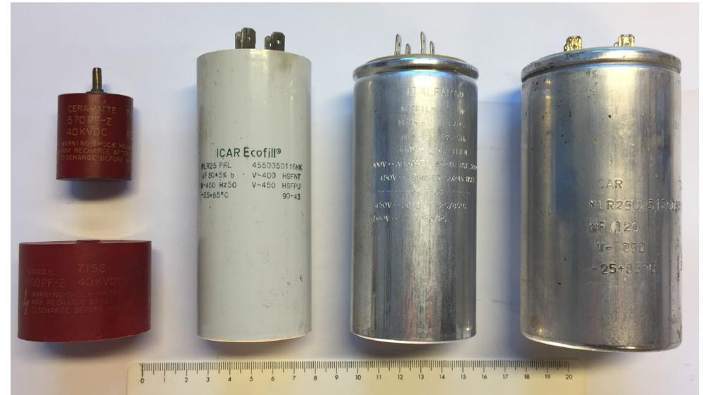
Condensatori per centinaia e migliaia di volt, per apparecchi di maggiore potenza. Le capacità vanno dai picofarad ai microfard.
