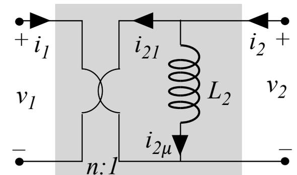
n.b.:  $L_1 = n^2 L_2$  ! è il **trasferimento di induttanza** del trasformatore ideale, analogo al trasferimento di resistenza già noto
