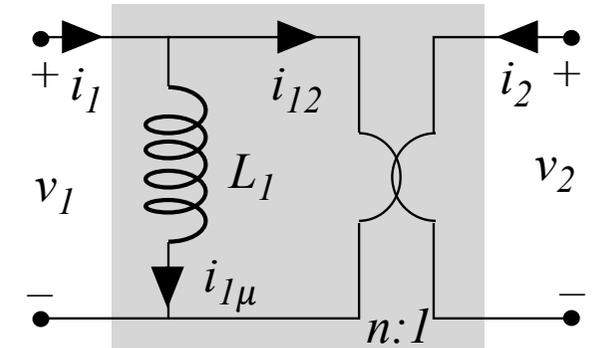
descrivono lo schema a lato = schema equivalente con trasformatore ideale:  $n$  = rapporto di trasformazione
