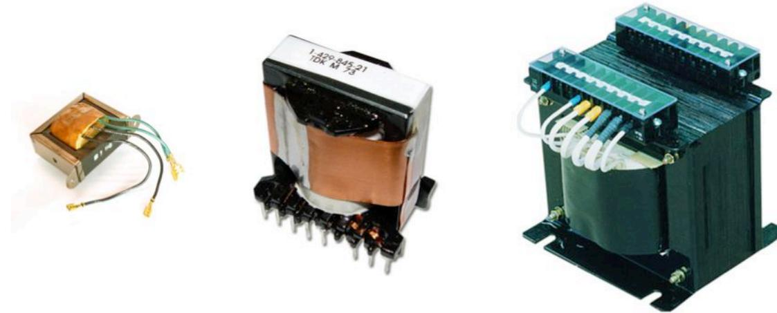
Trasformatori con nucleo magnetico di dimensioni e potenze modeste; quello a destra è un trasformatore di isolamento, con rapporto di trasformazione unitario, che svincola la connessione a terra (o a massa) del circuito a secondario da quella del circuito a primario
