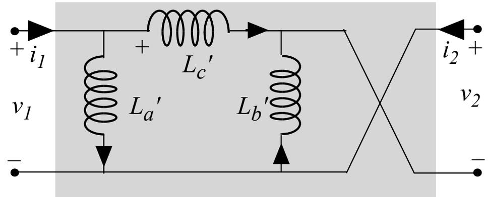
Dualmente alla sintesi a T, se  $M > 0$ ,  $\Gamma_M < 0$  si invertono i segni davanti a  $\Gamma_M$
