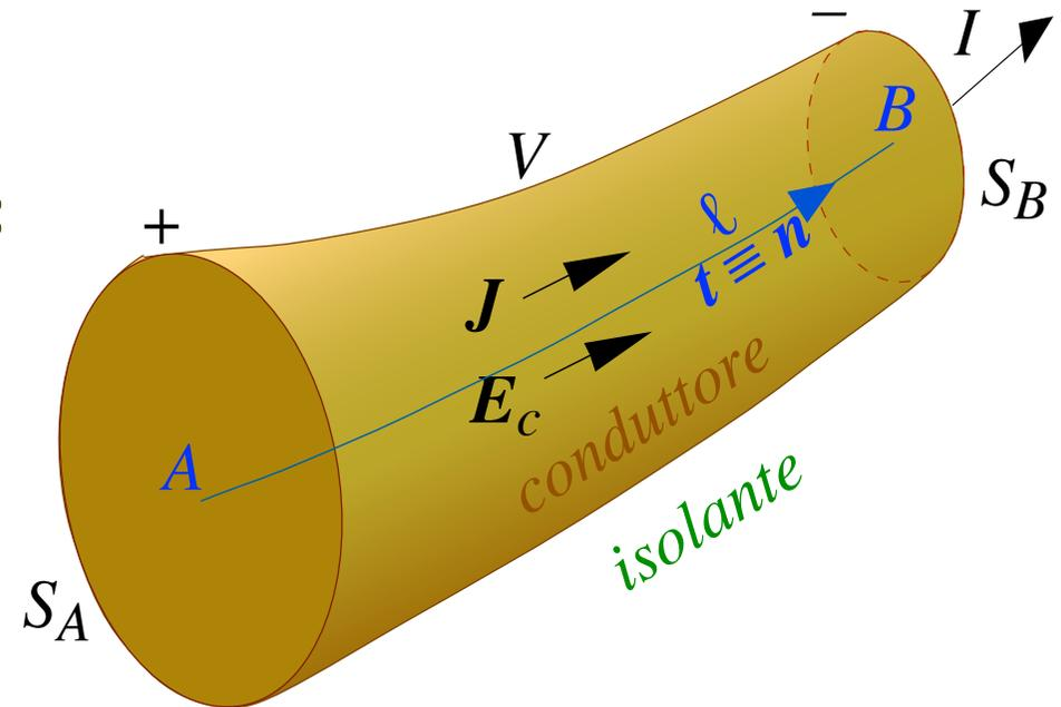
$R$  = resistenza del del tronco di tubo di flusso
