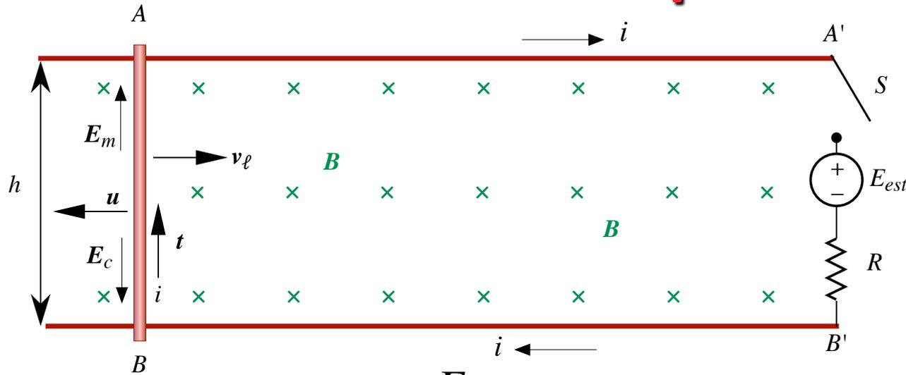
A carico:  $e_{AB} = v_\ell B h$        $i = \frac{e_{AB} - E_{est}}{R}$
