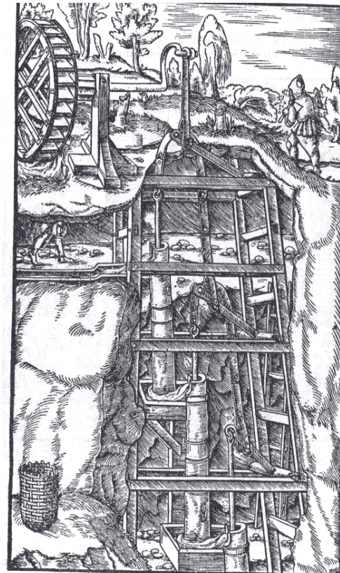
FIGURA 20—Drenaggio di una miniera. Pompa aspirante a tre stadi, azionata da una ruota a pale.
