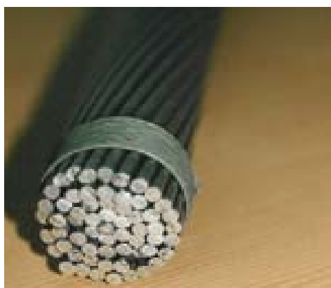
conduttore in Aldrey (lega di alluminio)
