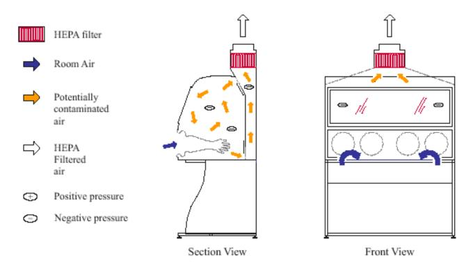
Le cabine di classe II, le più diffuse, offrono un compromesso di protezione prodottooperatore-ambiente. Mediante una barriera di aspirazione frontale, impediscono all'aria di passare dall'interno all'esterno della cabina verso l'operatore (tenuta dinamica). Un flusso laminare verticale di aria sterile protegge il prodotto nella zona di lavoro.
