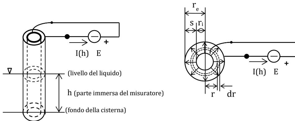
*Assumendo che la parte non immersa del resistore sia in aria, determinare come varia la corrente  $I(h)$  al variare del livello  $h$  del liquido fra 0 e 1000 mm (fare un grafico o calcolare per alcuni valori di  $h$ ) quando il resistore è alimentato con una tensione  $E=12\text{V}$ .*
