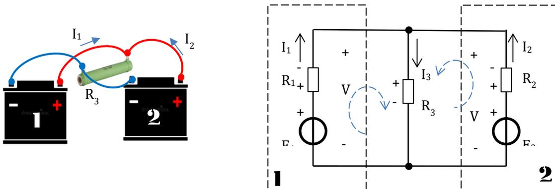
Il problema offre l'opportunità di riprendere i metodi di soluzione (trovare le tensioni e le correnti dati i parametri) dei circuiti elettrici. Il circuito elettrico da risolvere è quello di destra (che riproduce la struttura fisica di sinistra). Lo risolveremo in due modi diversi.
